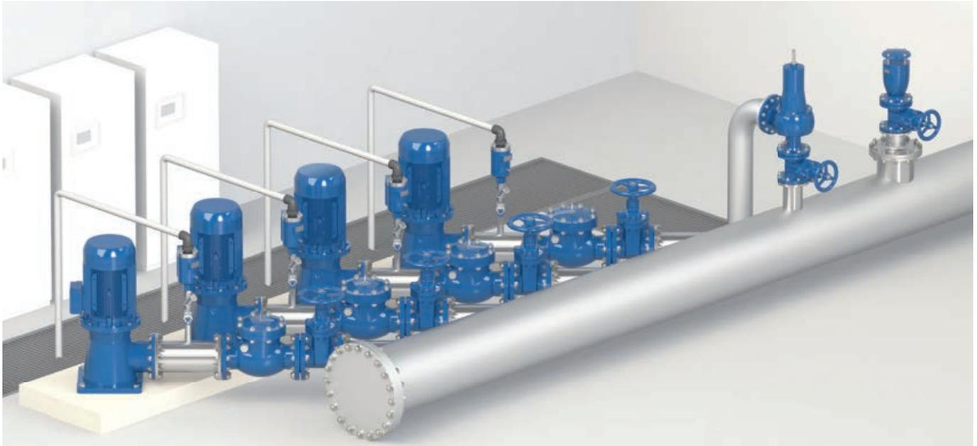
**Estación reductora de presión.** H-PVS 90F se instala aguas abajo de la estación reductora de presión para prevenir sobrepresiones en la línea. La instalación incluye la válvula reductora de presión H-VAL 310/410, con su filtro y válvulas de corte, un bypass para mantenimiento, y ventosas combinadas WAVE o WAVE LITE 3S-AWH aguas arriba y aguas abajo.
