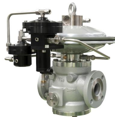
**Reval 182** est l'un des **régulateurs de pression pour gaz pilotés** conçus et fabriqués par Pietro Fiorentini. Cet appareil est adapté à une utilisation avec des gaz non corrosifs préalablement filtrés, et il est principalement utilisé pour les réseaux de distribution de gaz naturel à moyenne et basse pression. Selon la norme européenne EN 334, il est classé comme Fail Close (pilote série 200/A) ou Fail Open (pilote série 210/A) en fonction du pilote installé (sauf pour le monitor PM/182).
